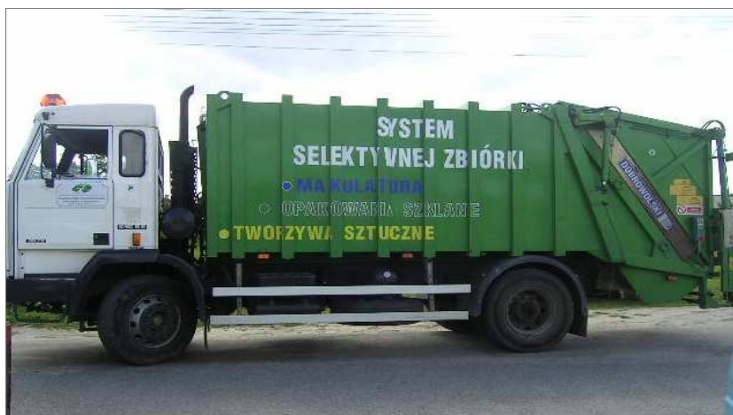
Fot. 6. Samochód specjalistyczny do opróżniania pojemników 1100 dm 3
